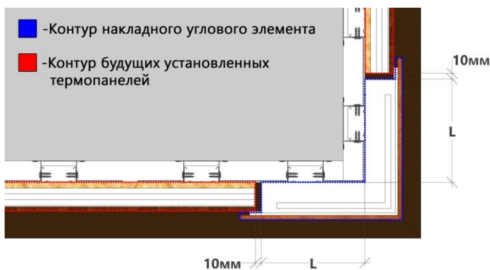
Рис. 3.1 Монтаж накладного углового элемента
