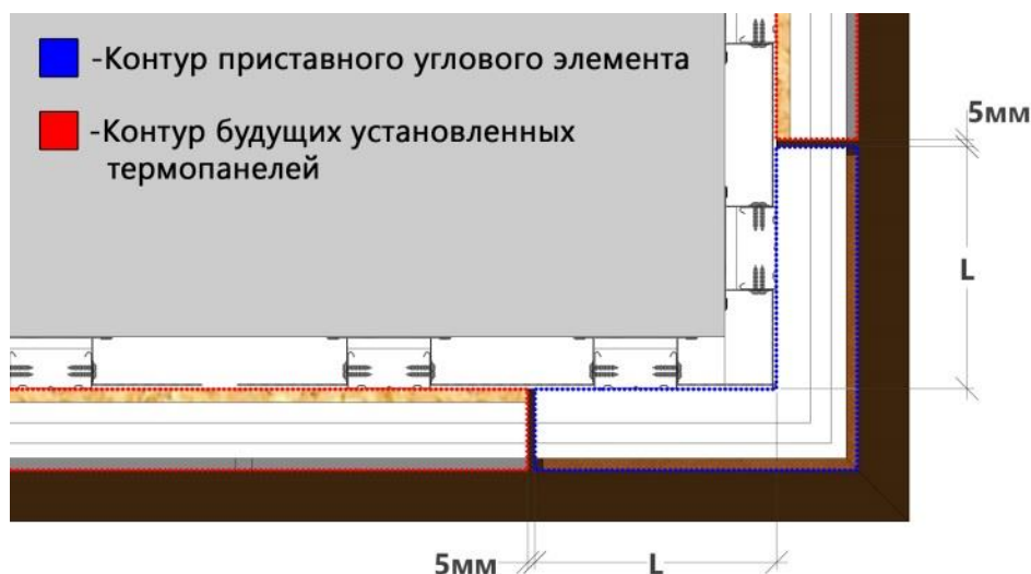
Рис. 3.2. Монтаж приставного углового элемента
